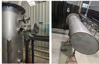
Diseño y construcción del prototipo de sistemas de adsorción de SH 2 y SO 2 con adsorbentes basado en hierro por parte de Inercio Biogás.
